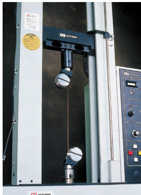
Контроль за качеством включает в себя тестирование поступающих партий проволоки на предел прочности и растяжения.
