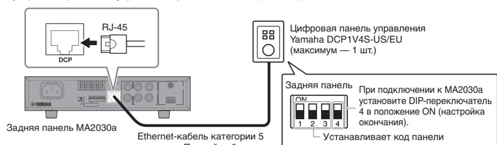
Функции регуляторов и переключателей DCP1V4S-US/EU можно настроить с помощью DIP-переключателей на задней панели DCP1V4S-US/EU.
