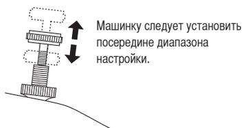
**2** Поместите шаровой наконечник (на конце струны) в прорезь для струны в машинке. Убедитесь, что шаровой наконечник правильно вставлен в прорезь машинки.
