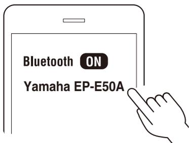
В случае успешного подключения вы услышите аудиосообщение «Pairing Successful». Индикатор на данном продукте загорится синим цветом (примерно на 20 секунд).
