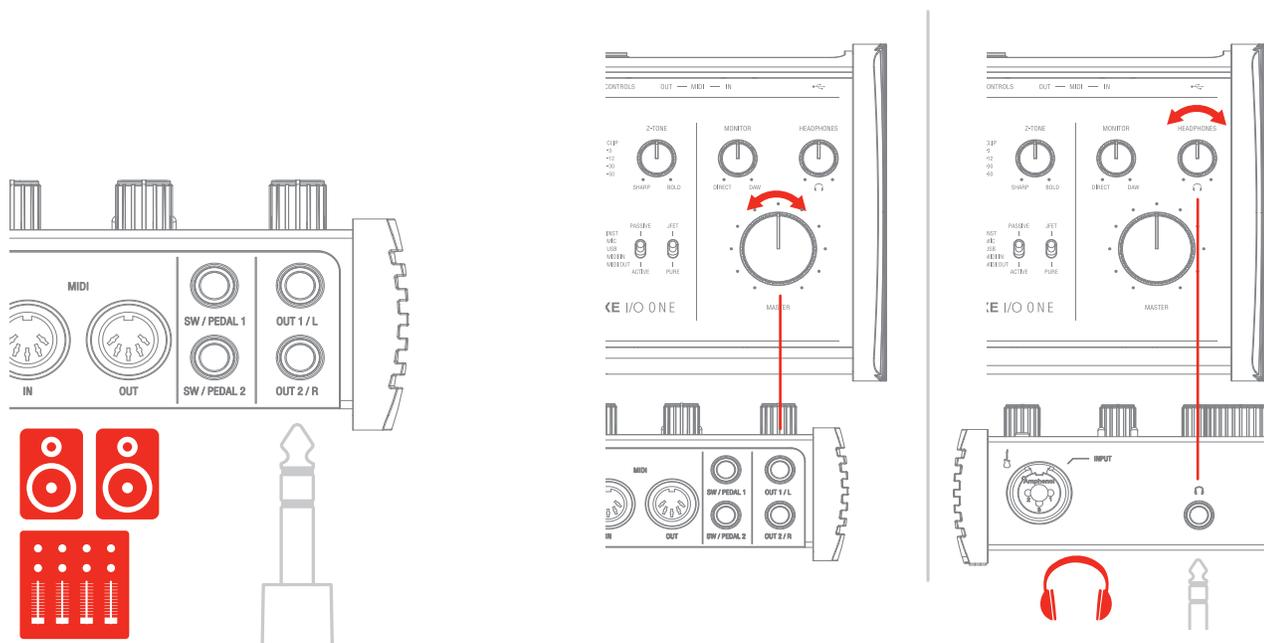
リアパネルのメイン出力1/Lと2/Rは、1/4"TRSプラグのバランスケーブルを使用して、アクティブ仕様（パワーアンプ内蔵型）のモニタースピーカーと繋ぐことが可能です。パワーアンプを装備しないパッシブ型のスピーカーをご利用の場合、AXE I/O ONEの入力をスピーカーを鳴らす為のステレオアンプの入力と接続をします。
