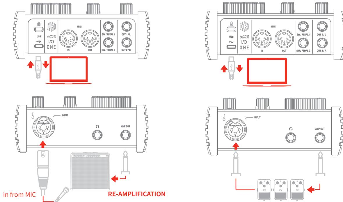
AXE I/O ONEには、ギタリストのスタジオレコーディングで一般的に行われているリアンプ (Re-Amplification) と呼ばれる行為に特化した機能が備えられています:3番目の出力として用意された“AMP OUT”はその為のもので、メイン出力の1-2とは独立し、特別な仕様になっています。この出力を用いることで、既にコンピューターソフトウェアでライン収録したトラックを実際のギターアンプやギター用のストンプエフェクトを直接繋いで、ギターサウンドを再形成することが可能です。勿論、その間、メイン出力1-2で、セッションのモニターを行いながら、アンプやストンプを通したサウンドの再収録が可能です。また、AMP OUTを用いることで、新たにリアンプをする為のデバイスを用意する必要がなくなります。
