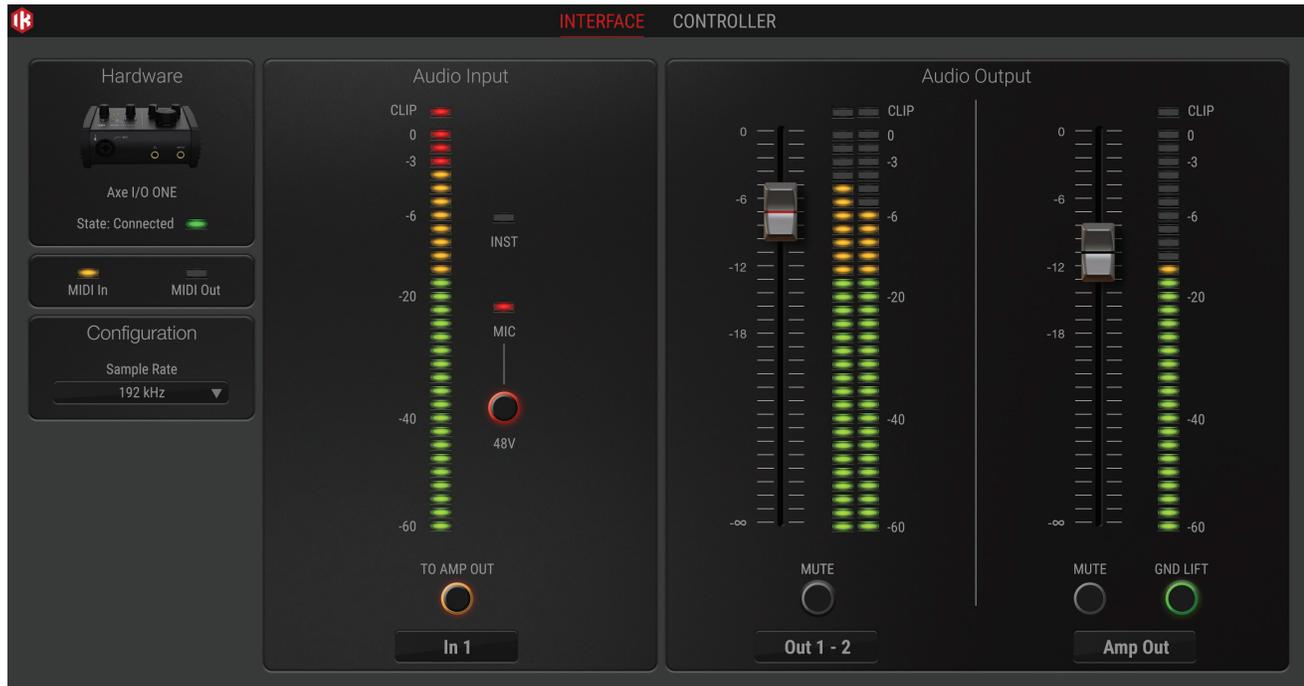
**State :** AXE I/O ONE本体と正しく接続されている場合、Connected LEDが緑色に点灯し、そのことを示します。
