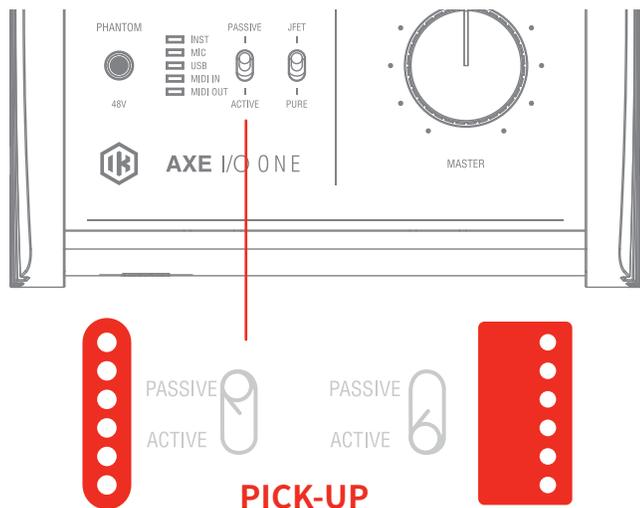
AXE I/O ONEはまた、ギター入力に対する妥協はありません。エレキギターのパッシブピックアップ (Passive) とプリアンプを装備したアクティブピックアップ (Active) 入力に対する最適な入力回路もそれぞれ独立して用意され、切り替えることが可能です。パッシブピックアップのエレキギターは、アクティブピックアップよりも高出力インピーダンスで、AXE I/O ONEのPASSIVEモードはその名の通り、パッシブピックアップ出力に最適化されています。ACTIVEモードは、プリアンプ (電池駆動する) 出力を持ったエレキギターに最適化したモードです。
