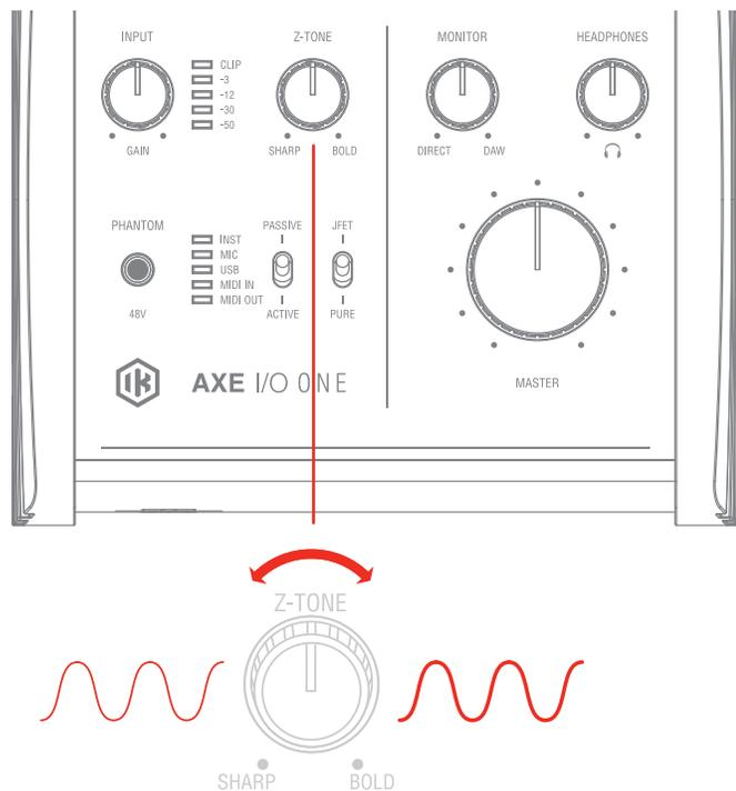
全てのパッシブピックアップ(シングルコイル、ハムバッカー、タップなど...)は、そのロードインピーダンスによって、音色の性質やキャラクターが決定付けられます。つまり、オーディオインターフェイスの入力が単に高出力インピーダンスを受けられる仕様なだけでは、ギターをアンプに繋いだ際と同様の音色が得られないことがあります。AXE I/Oはこの問題を解消する為、ギターのライン入力からより音楽的な音色を得る為、入力インピーダンスに可変コントロールを設けました。フロントパネルのZ-TONE™コントロールは、楽器入力 (Instrument Input) の入力インピーダンスを接続楽器に合わせて設定することで、その音色をよりクリエイティブに整えることが可能です。
