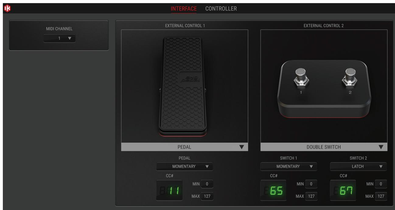
CONTROLLERタブは、コントローラー入力で扱うMIDIチャンネル、動作モード、MIDI情報 (CC#)、操作時の最大値と最小値などを設定します。コントロール情報の受け手となるソフトウェア側のパラメーターに合わせて、設定をします。
