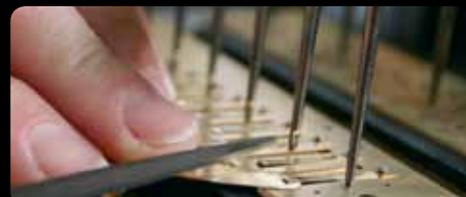
На третьей фотографии показан процесс настройки, при котором высота тона каждого язычка тщательно настраивается. Подбирается высота, идентичная высоте тона язычка на эталонном образце, который можно увидеть на столе позади настраиваемого образца.
