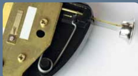
2. Снимите пружину
